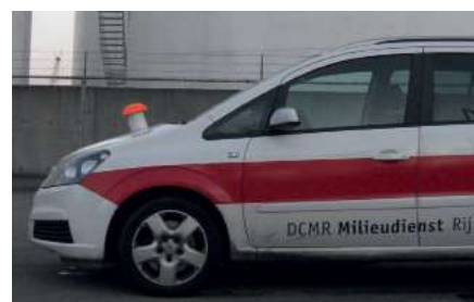
Figuur 2: Het prototype van de mobiele e-nose (hier op de motorkap van de auto).
