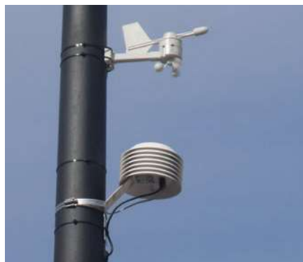
Figuur 1: E-nose en windmeter aan een lantaarnpaal.
